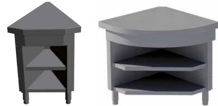
Construction inox AISI 304. Dessus inox ép. 20/10e. Façade stratifiée à 15 mm du sol - HT 900 mm
