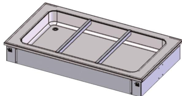
Cuve à encastrer réalisée en acier inox AISI 304, complètement soudée. Cuve avec angles arrondis, profondeur 215 mm pour bacs 2, 3, 4, 5 et 6 GN1/1 et/ou lit de glace. Isolation par mousse isolante au HCFO. Vidange 1/2". Peut être accessoirisée avec superstructure, éclairage et bac d'évaporation.
