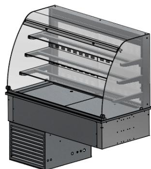
Vitrine arrondie à encastrer. Vitrine réfrigérée, ventilée par flux arrière. Ouverte côté "clients" avec rideau thermique ou fermée par vitre bombée (avec vérins permettant le relevage de la vitre pour le nettoyage). 2 portes coulissantes en plexiglas double paroi avec micro-perforations pour flux d'air laminaire. Isolation par mousse isolante au HCFO.
