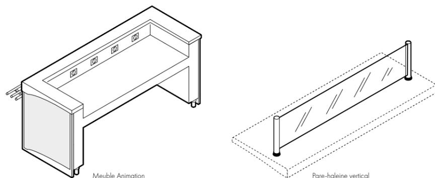
Construction inox Aisi 304. Dessus inox Aisi 304, ép. 20/10e. Bord avant rayonné. Façade stratifiée à 15 mm du sol et rampe inox 3 lisses incluses. Meuble neutre ouvert avec décaissé de 250 mm (220 mm pour les granits) pour recevoir des modules (non fournis).
