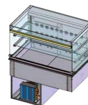
Vitrine rectangulaire à encastrer. Vitrine réfrigérée, ventilée par flux arrière. Ouverte côté "clients" avec rideau thermique ou fermée par vitre (avec vérins permettant le relevage de la vitre pour le nettoyage). 2 portes coulissantes en plexiglas double paroi avec micro-perforations pour flux d'air laminaire. Isolation par mousse isolante au HCFO.
