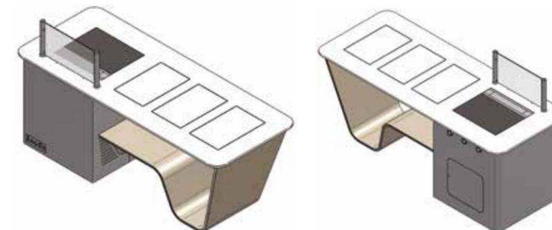
Structure construction inox AISI 304 et menuisée avec incrustation LED suivant la courbe du soubassement
