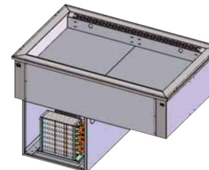
Cuve à encastrer, réfrigérée par froid statique, décaissé de 110 mm pour présentation boissons. Isolation par mousse isolante au HCFO. Construction en acier inoxydable Aisi 304. Température de fonctionnement +2°C/+10°C. Groupe frigorifique 56 dB(A) maximum sur plancher extractible fonctionnant au gaz réfrigérant R455A. Alimentation mono 240v.
