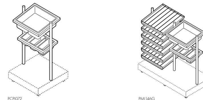
Construction inox Aisi 304. Cadres supports fixés sur tubes inox Aisi 304 ø 40 mm polis, recevant les bacs en copolyester GN1/3 pour les couverts. Capacité : 100 sets de couverts pour 3 bacs GN1/3. Bacs en copolyester (sans bisphénol A) fournis.
