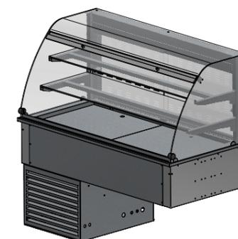
Vitrine arrondie à encastrer. Vitrine réfrigérée, ventilée par flux arrière. Ouverte côté "clients" avec rideau thermique ou fermée par vitre bombée (avec vérins permettant le relevage de la vitre pour le nettoyage). 2 portes coulissantes en plexiglas double paroi avec micro-perforations pour flux d'air laminaire. Isolation par mousse isolante au HCFO.
