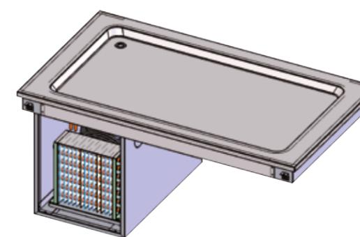
Vitrine rectangulaire à encastrer. Vitrine réfrigérée, ventilée par flux arrière. Ouverte côté "clients" avec rideau thermique ou fermée par vitre (avec vérins permettant le relevage de la vitre pour le nettoyage). 2 portes coulissantes en plexiglas double paroi avec micro-perforations pour flux d'air laminaire. Isolation par mousse isolante au HCFO.
